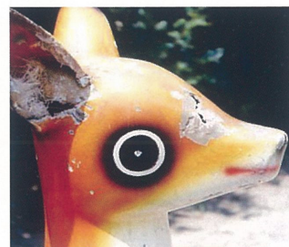
FRPのガラス繊維の露出
