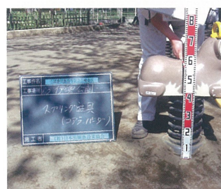
落下高さの測定
